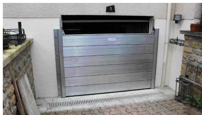
La barrière rigide est prévue pour une mise en place manuelle opérée par un ou plusieurs opérateur(s) selon la longueur de l'ouverture. Elle nécessite la pose de poteaux d'ancrage permanents sur les bords droit et gauche de l'ouverture. Elle se compose de panneaux en aluminium d'une hauteur fixe de 250 mm munis de joint en EPDM. Selon le volume potentiel de liquide à confiner ou à bloquer, la barrière fera de 250 mm de hauteur jusqu'à 2000 mm.
