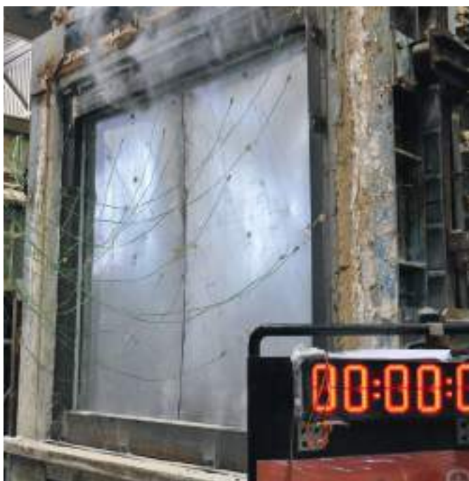
Prova di resistenza al fuoco della porta. Fotografia durante la prova
